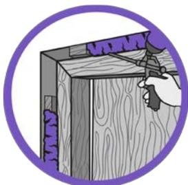
OLIVÉ PU-46 MULTIUSO pistola se utiliza especialmente para RELLENO de agujeros y huecos, la instalación de marcos de ventanas y puertas, y el sellado de juntas.
